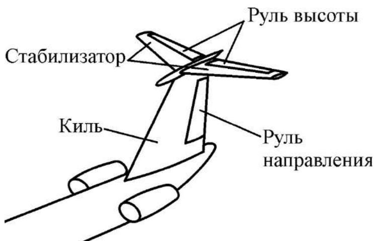
Рисунок 5. Хвостовое оперение
