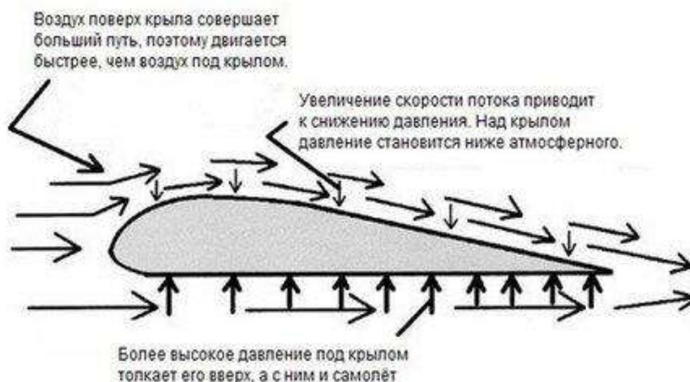
Рисунок 7. Аэродинамическая сила
